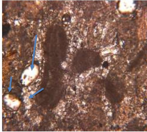
صورة (١١) توضح أصداف دقيقة في أرضية الكالسيت C.N (x٦٣).
