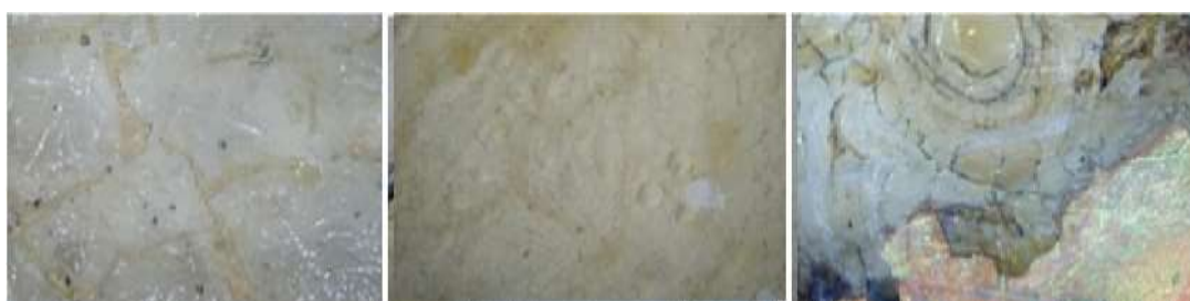
لوحة (٨) توضح شكل اصفرار مادة العزل وانتشارها باستخدام الميكروسكوب الرقمي
