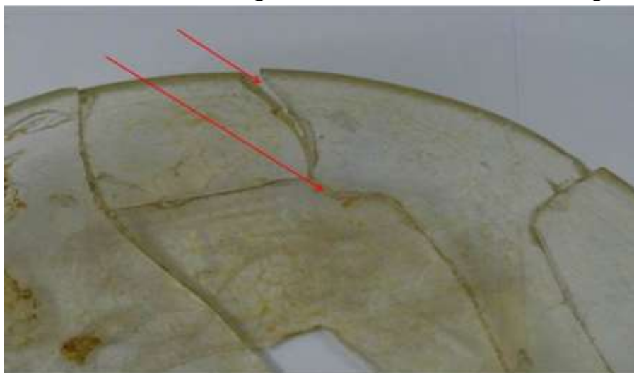
صورة (١) توضح الإصفرار بسطح الزجاج وأماكن الترحيل بالأجزاء المجمعّة بالطبق الزجاجي
